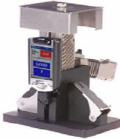
**Figure1.** ALLOY PRO 9388 Metal Analyser
